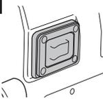
照明ON/OFFスイッチを「照明ON」の位置にすると点灯します。
