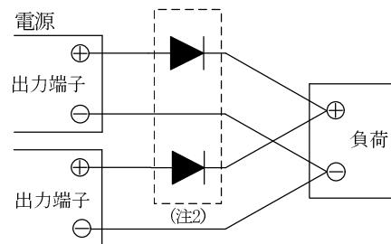
(注2) 逆流防止用ダイオードの順方向電流定格は、負荷電流に対して同等以上のものをご使用ください。
