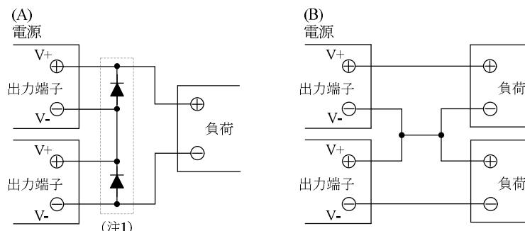
(注1) (A)の直列運転方法でご使用の際は、バイパス用ダイオードを接続してください。このバイパス用ダイオードの順方向電流定格は負荷電流に対して同等以上のものを、逆耐電圧定格は各電源出力電圧に十分耐えるものをご使用ください。
