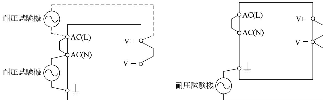
注1) 本機の出力 -  $\perp$ 端子間には積層セラミックコンデンサが使用されています。耐圧試験機の種類によつては印加電圧が歪み、高電圧が発生して電源破損をまねく恐れがあります。耐圧試験実施時には印加電圧波形の確認をお願いします。
