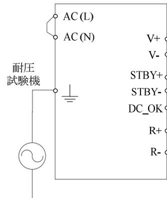
注1) 本機の出力 - ↓端子間には積層セラミックコンデンサが使用されています。耐圧試験機の種類によっては印加電圧が歪み、高電圧が発生して電源破損をまねく恐れがあります。耐圧試験実施時には印加電圧波形の確認をお願いします。
