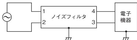
ブロック端子タイプのアース端子⊕は両方とも金属ケースに接続されていますので、どちらを電子機器のフレームグランドに接続してもかまいません。
