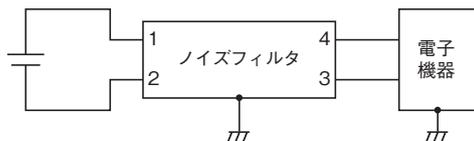
(FG)端子は両方とも金属ケースに接続されていますので、電子機器のフレームグランドに接続してもかまいません。また、接地用端子としても使用できます。
