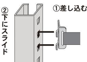
●差し込み式金具のフック部を支柱の棚板取付穴に差し込み、下にスライドし固定します。
