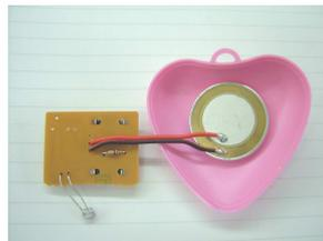
図のよう両面テープでスピーカを正面側ケースの内側に固定します。
