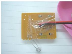
スピーカーとの接触で誤動作しないように電池金具と光センサーの足の部分にセロハンテープを貼り付けてください。
