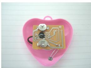
電池を取り付けて、基板を写真の位置に置きます。裏ふたを閉めたときに、各部が無理にならないように調整します。
