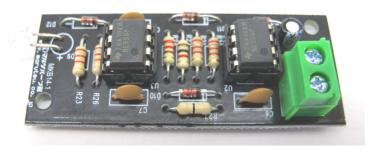
部品間違いがないか、よく確認してください。 IC ソケットに、555IC を取り付けてください。 1番ピンの位置を合わせて取り付けてください。
