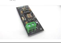
ターミナルの電線接続口を外側に向けて取り付けてく ださい。
