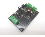
ターミナルの電線接続口 を外側に向けて取り付け てください。 10. リレーの取り付け (L1)
