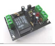
基板の4隅にある、固定穴に差し込んで取り付けてください。 部品のつけ間違いがないか、はんだづけ不良がないか、再度確 認してください。
