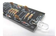
赤外線 LED の照射方向向 きにリード線を加工して 取り付けます。
