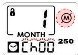
給油装置が閉塞等により停止した際、**モーター過負荷**アイコンがLCDに表示されます。
