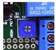
**使用上の注意:対象物の検出には約1秒以上時間が必要です。対象物が小さいと超音波は風やさまざまな影響で反射して戻る超音波が乱れる場合があります、対象物があっても一瞬検出されない(リレーがオフになる)場合があります。超音波信号はまわりの壁、突起、風などで乱れるため、正確には調整できません。狭い部屋などでは反射する超音波が乱れるため約10cmに設定すると対象物がなくても反応する場合があります。原理上、対象物の大きさとしてセンサーからの距離に比例してある程度の大きさが必要です。**
