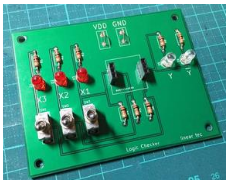
図 1: 組み立てた「動作チェッカ」。
