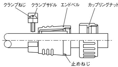
3.各使用ケーブルのシース及び電線を次ページの寸法で剥く。
