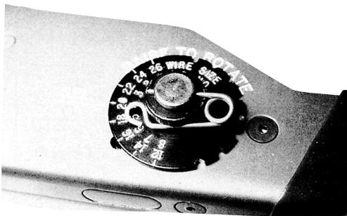
2. 圧着するコンタクトと電線サイズによって、セレクターの番号をセットする。
