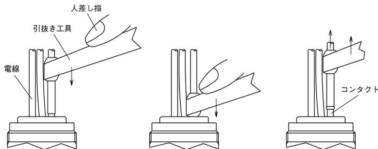
④引き抜いたコンタクトを正しい端子番号の穴に挿入する
