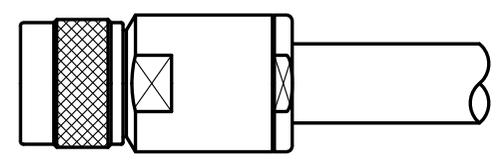
⑤ シェルを装着し、締付金具をスパナ等で締め付けて作業を完了する
