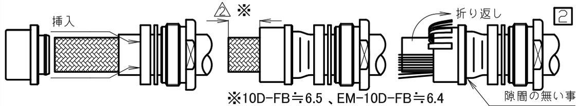
② ケーブルの外部導体とシースの間にクランプを挿入し、外部導体をほぐし折り返して切りそろえる。アルミ箔/銅箔はたんざく状に切り折り返し、外部導体の上に撫で付ける。この時、クランプはケーブル外皮との隙間が無くなるまで挿入する事
