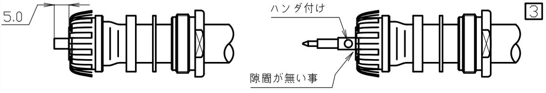
③ 絶縁体を指定の寸法で切り取り、中心コンタクトをハンダ付けするハンダ付けの後、中心コンタクトを手で引張り抜けない事を確認する
