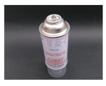
硬化剤を塗料液側に流し込むため、缶を 逆さまにして 10 分程度放置します ※この工程が非常に大切です。必ず 10 分 程度放置してください
