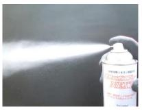
放置後、スプレー缶を良く振り、塗料液と硬化剤を混合攪拌した後、施工箇所から 20cm 以上離してスプレーします可使時間がありますので、塗料液と硬化剤混合後はなるべく 24 時間以内に使い切ってください。72 時間以上たったものは使用しないでください
