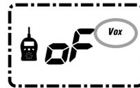
2. “UP/DOWN” キーで1～5の音の感度調整をします。5より小さな音に反応します。ハンズフリー機能を使用しない時は、oF を選択してください。
