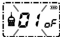
2. “UP/DOWN” キーを長押しすると、チャンネルスキャンが開始します。“UP” キーで今のチャンネルから順に進む方向にチャンネルをスキャンします。“DOWN” キーを長押しすると、戻る方向にチャンネルをスキャンします。
