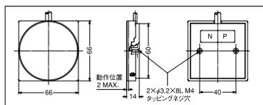
◆取付穴は(裏面孔径φ3.4×深さ8袋式)2ヶ所です。M4 タッピングネジB1をご使用の上、ネジシロ6~8mm以内で締付トルク78.4N (8.0kgf・cm)で行ってください。
