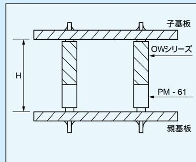
H寸法はPM-61を使用した場合の親基板と子基板の間隔です。
