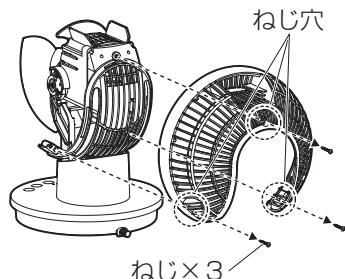
取り付ける際は、ねじ穴を合わせて背面ガードを本体に取り付け、ねじでとめてください。
