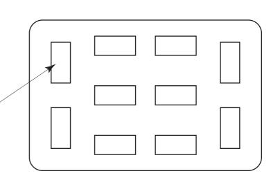
2 両面テープを貼り終えたゴムシートを合板積載面に載せ位置決めをする。 位置決めを終えたら図のようにゴムシートの片側を重量物等でズレないように押さえつける。
