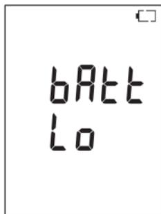
電池残量がなしの状態 (点滅) のとき、表示部に **[bAtt Lo]** を 2 秒間表示し、本器の電源が切れます。
