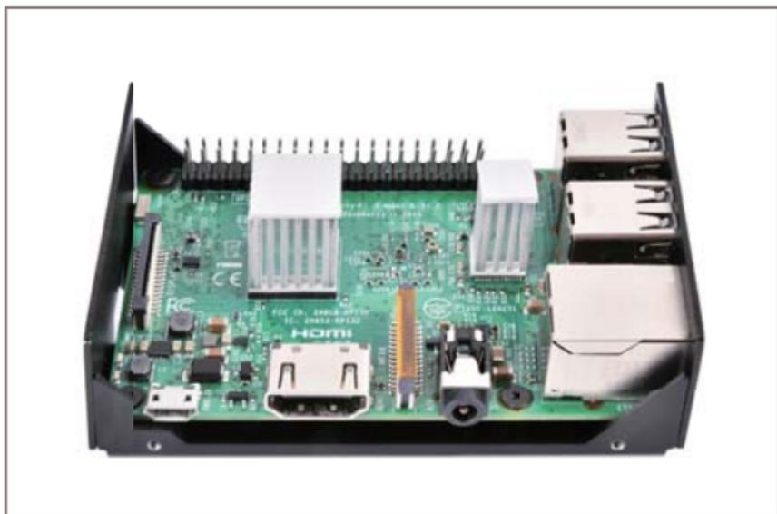
5 底部半分にアルミニウム製ケースを合わせ、ネジ止めます
