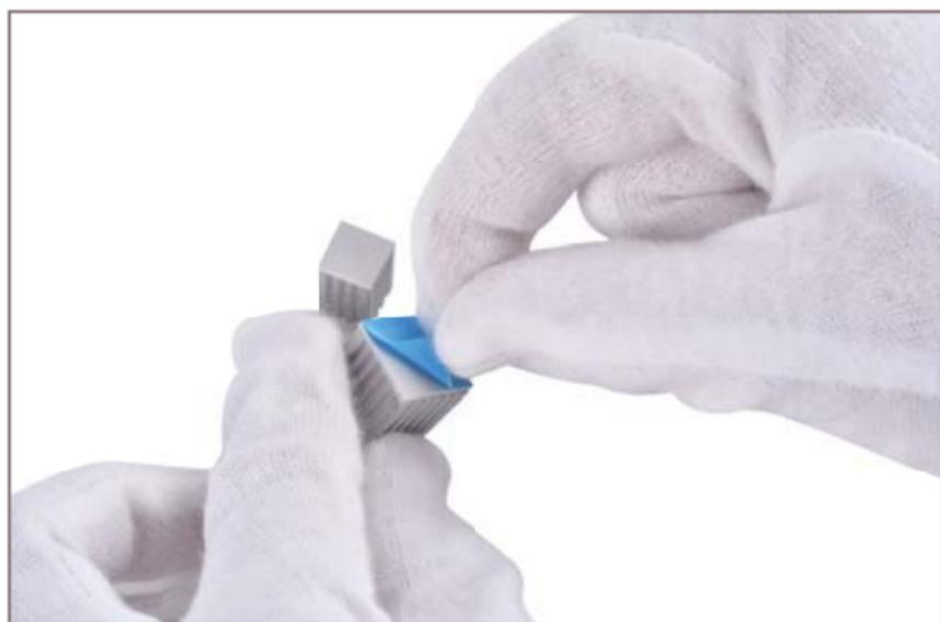
4 Raspberry PiのCPUおよびICにヒートシンクを置きます
