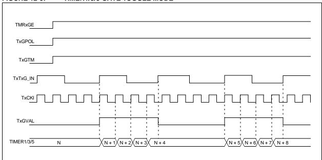
FIGURE 12-6: TIMER1/3/5 GATE SINGLE-PULSE MODE
