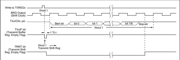
FIGURE 16-4: ASYNCHRONOUS TRANSMISSION (BACK-TO-BACK)
