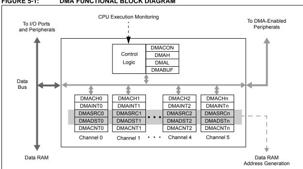
FIGURE 5-1: DMA FUNCTIONAL BLOCK DIAGRAM
