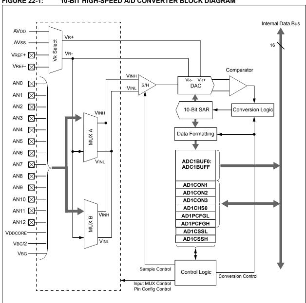
**FIGURE 22-1:** 10-BIT HIGH-SPEED A/D CONVERTER BLOCK DIAGRAM
