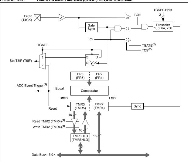
FIGURE 12-1: TIMER2/3 AND TIMER4/5 (32-BIT) BLOCK DIAGRAM
