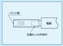
圧着の場合、工具はOMXT-1 (22ページ参照) (取付チップは取りはずして使用して下さい) を御利用下さい。
