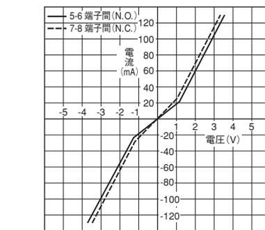
9. 開路時漏れ電流－負荷電圧特性
