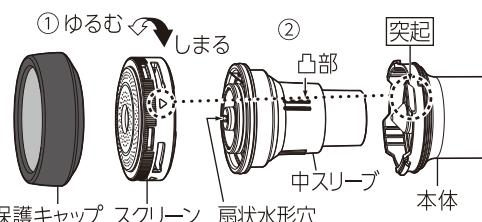
③お手入れが終わったら、中スリーブの凸部を本体内側の凹部にあわせて差し込んだ後、スクリーンの△印と本体突起部をあわせて差し込み、スクリーンをしまる方向に回して締め込みます。その後、保護キャップを取り付けます。
