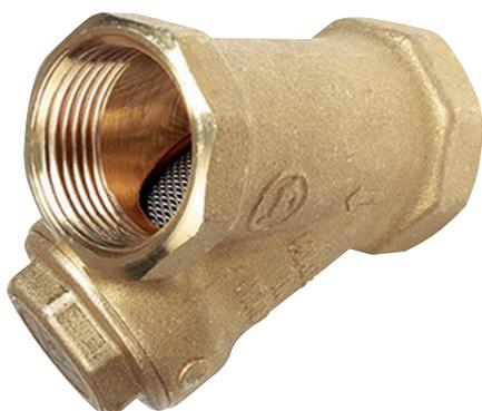
R74M形ストレーナは冷温水用のストレーナで本体は真鍮製です。ストレーナの内部にはフィルター以外に強力な磁石が内蔵されており、これにより微細な金属片をマグネット部に吸着させます。異物が配管内に入るのを防ぎます。
