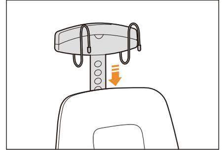
**2** ホルダーを背もたれに挟み込んで取り付けます。しっかり固定させる為、多少背もたれに食い込むように調整してください。
