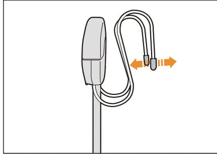
**1** ホルダーをイスの背もたれの厚さにあわせて調節してください。ホルダーはアルミ製なので曲げることができます。
