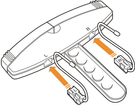
ホルダーのR/Lを確認し、本体底面の角穴に差し込みます。レバーのツメが『カチッ』と音がするまでしっかり入ったら完成です。レバーをつまみながら引き抜けば、ホルダーを取り外せます。
