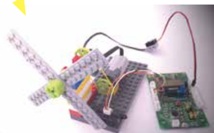
●エコで安全な扇風機 人を感知して動作、近すぎると羽根停止
