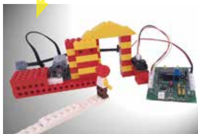
●自動ドアの仕組み ドアの動きを簡単制御
