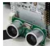
・超音波センサで、障害物回避をします。
