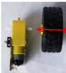
①モータ出力軸とホイールの差込口の長円形の方を合わせます。
