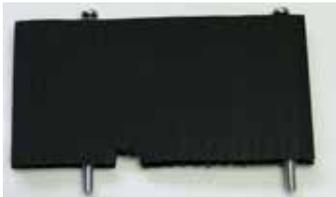
プラダン仕切板取付位置に、ベースボード下部より部品取付時のネジ先端がありますので、左図のようなナット高さ分の切れ込みを作ります。ネジ部はプラダンに入ります。切れ込み位置は現物合わせで決めます。
