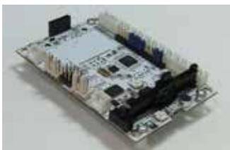
※基板に取り付けてあるネジM3x6mmは、あとで基板取付時に使用しますので、保管ください。
