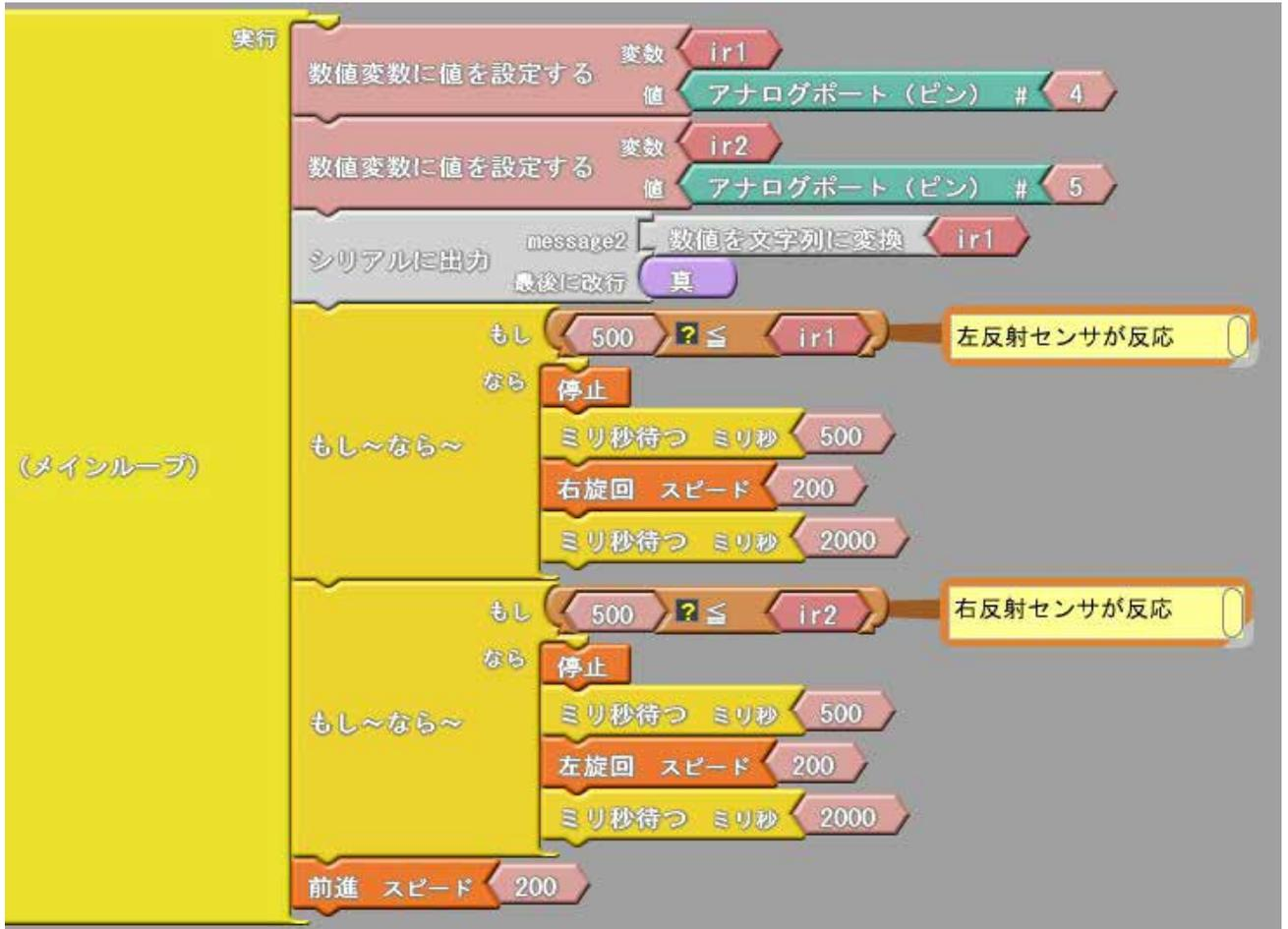
(1) 上図を参考にプログラムを作成し、コントローラへアップロードしてください。赤外線反射センサ RDI-211 を使用して床の明暗に反応して動くプログラム例です。白いラインがあったら旋回してフィールドに戻ります。
