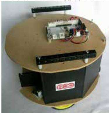
本ロボットには、部品追加が可能なようにM3x10mmのネジをTOPに出していますので、六角高ナットを取り付けることで、設計を拡張できます。
