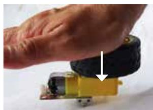
③最後に、図のように、出力軸の反対側を台に当てて、タイヤを上から手の平で押さえて差し込みます。
