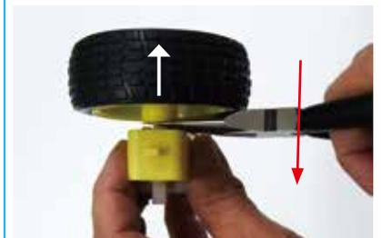
ギアボックスとホイールの間にラジオペンチの先を差し込み、ラジオペンチをゆっくりとこねてホイールを真上へ抜きます。
