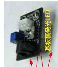
センサ裏面の発光LEDから赤外線を発光し、床に照射します。床からの反射波を受光LEDで計測するセンサです。白が大きく反射、黒は反射が少ないなど色の違いにより光の反射量は変化します。
