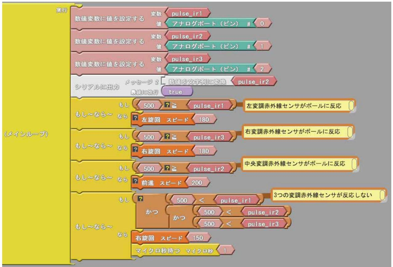
変調赤外線センサ RDI-203JR を使用して赤外線ボールを探すプログラム例です。
