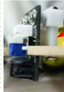
この樹脂スペーサの高さを変え、床との距離を変え、反射受光量が変わり、データが変化します。
