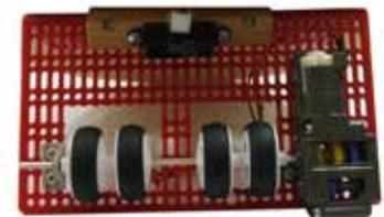
ドリブラーのほぼ中央に、測距センサー(レンジセンサー)を取り付ける
