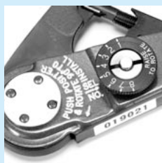
②圧着工具で締めつける。電線の太さによりダイヤル(1~8)を調整する。
