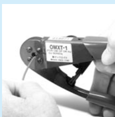
①ソケットを圧着工具に入れ、ソケットの穴の中に電線を入れる。 ●圧着工具の先端に適合ツールをつけて下さい。
