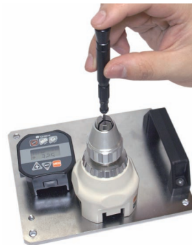
微小トルクドライバ AMRD の ATGE によるトルクチェック例 (オプションの ATGE 測定台を使用)
