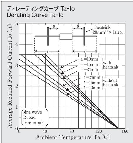
\* Sine wave は 50Hz で測定しています。
