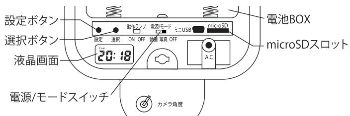
本体正面を自分に反応するように向けると、人感センサーが反応してセンサーライトが点灯し、動作ランプが赤点滅を開始し、撮影が始まります。動作ランプ表示は下記のように表示されます。動作中は液晶画面に現在時刻が表示されます。最後に撮影した画像をパソコンで確認します。(下記⑩参照)動作確認が終わりましたら、センサーライトの設定、カメラの設定をお好みの設定にしてください。
