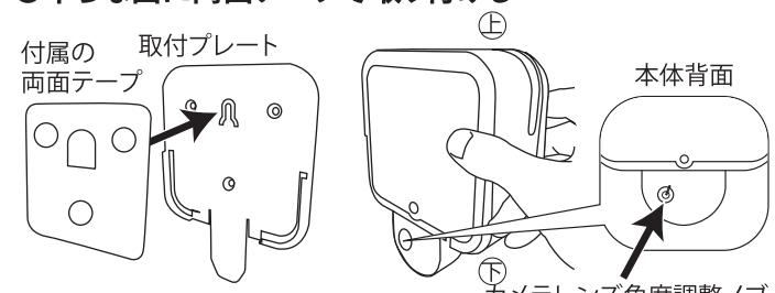
カメラ本体背面のカメラレンズ角度調整ノブでカメラの向きを合わせ、付属の両面テープを取付プレート裏面に貼り、本体にセットし平らな面に貼り付けます。
