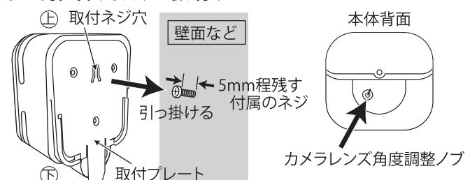
カメラ本体背面のカメラレンズ角度調整ノブでカメラの向きを合わせ、壁面などに付属のネジを+ドライバーでねじ込み、5ミリ程残し、取付プレートの取付ネジ穴に引っ掛けます。
