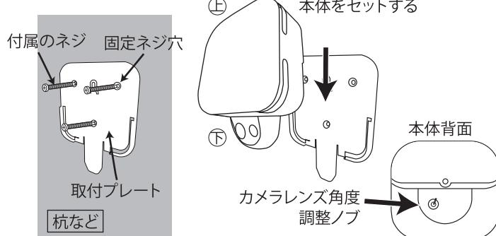
カメラ本体背面のカメラレンズ角度調整ノブでカメラの向きを合わせ、杭などに付属のネジ3本で取付プレートの固定ネジ穴にねじ込み固定します。
