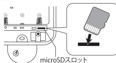
向きに注意して“カチッ”と押し込む ※外すときは“カチッ”と押し込むと出てきます。
