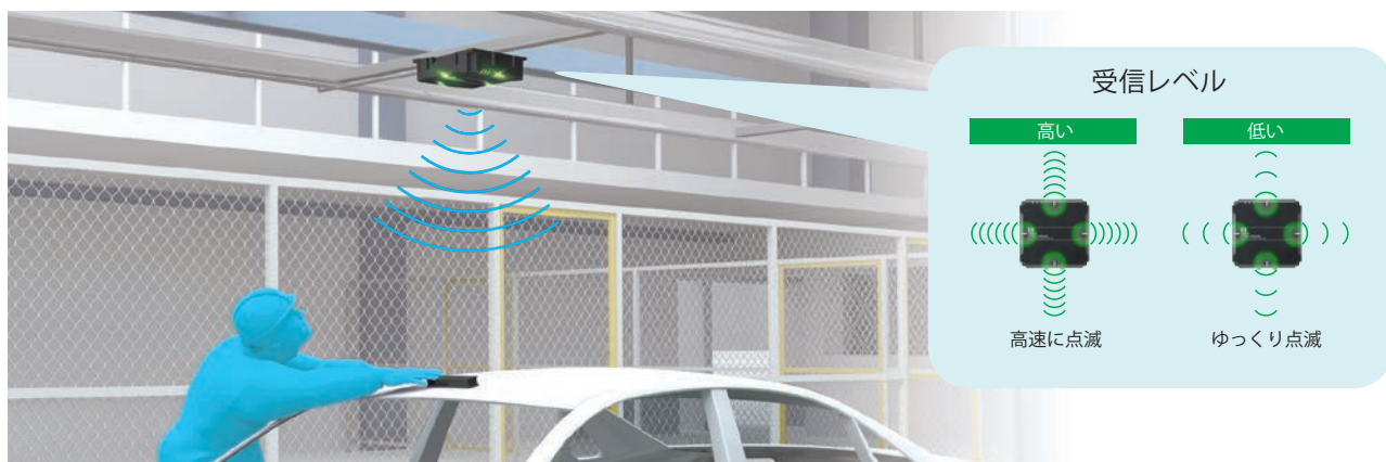
リーダライタのLEDを見ながら、受信レベルが高くなるようにRFタグの取付位置を調整
