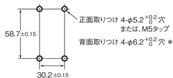
\* コンジットサイズ アース端子仕様が「TS 1/2-14NPT アース端子あり」の場合は、背面取り付け 4-φ6.2<sup>+0.2</sup> 穴になります。
