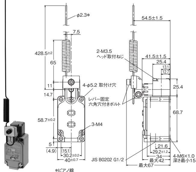
注. 各機種の外形寸法図中、指定のない部分の寸法公差は±0.4mmです。
