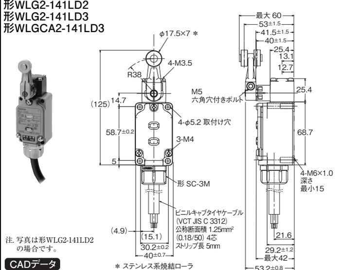
注: 各機種の外形寸法図中、指定のない部分の寸法公差は±0.4mmです。
