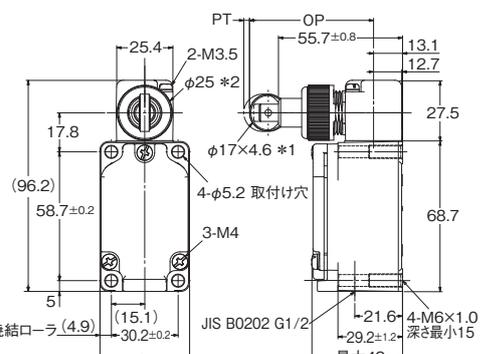
注. 各機種の外形寸法図中、指定のない部分の寸法公差は±0.4mmです。
