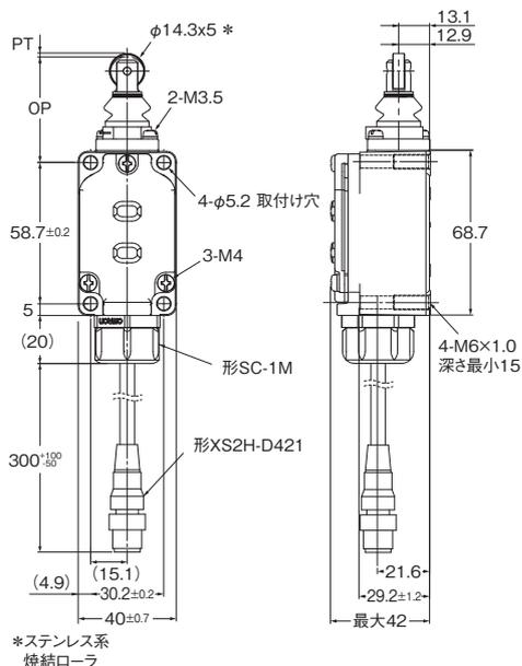
注: 各機種の外形寸法図中、指定のない部分の寸法公差は±0.4mmです。
