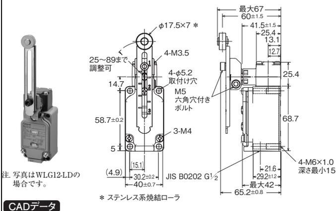
注: 各機種の外形寸法図中、指定のない部分の寸法公差は±0.4mmです。
