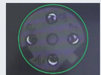
位置ずれによる穴の見え方の違いを考慮した良品画像を復元
