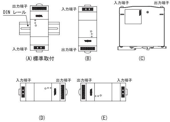
■DINレールに取り付ける場合は、確実にDINレールに取りつくよう、A部をレールの一端に引っ掛け、B方向に押し込んでください。取り外す際には、C部を押し下げるか、D部にドライバ等を差し込み引き外してください。取り外しにくい場合は、E部を押しながら作業してください。
