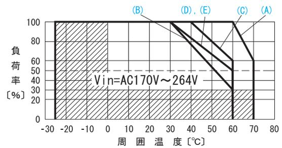
■ 強制通風時のディレーティング特性を以下に示します。
