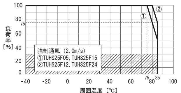
■ 出力電流のディレーティングを行うことによって、-40°Cから上図に示す最大温度までご使用いただけます。
