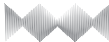
インバータ2次側漏電電流波形イメージ 電流値が増減を繰り返す。
