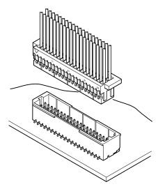
基板対電線用最小の 1.0mm ピッチ、2 列構造を採用。 組立実装高さ 6.3mm (トップ)、5.5mm (サイド)、幅 5.0mm (トップ)、5.1mm (サイド) のロープロファイル設計で、機器の 小型化・高密度実装化の要求に対応しました。
