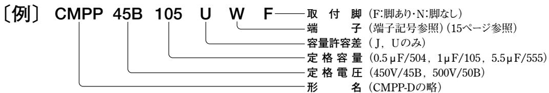
**Type CMPS** …保安機構付交流用SHコンデンサ(80°Cタイプ)・UL・CSA認定品
