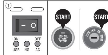
①本製品のAC用電源スイッチが「OFF」になっていることを確認して、エンジンスイッチを「ON」にする。
