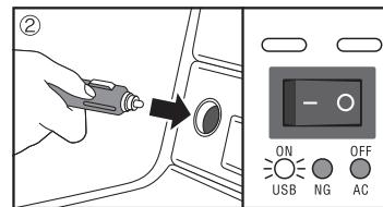
②本製品の電源プラグをアクセサリーソケットに接続すると、USBランプが点灯してUSBが使用可能になる。
