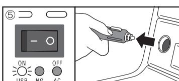
⑤本製品のAC用電源スイッチを「OFF」にし、アクセサリーソケットから本製品の電源プラグを抜く。
