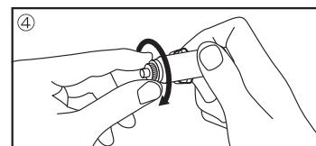
④端子カバーを取り付け、電源プラグのカバーを時計回りに回す。
