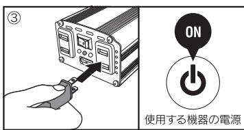
③本製品のACコンセントに使用する機器の電源プラグを接続し、使用する機器の電源を「ON」にする。
