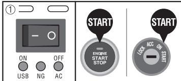
①本製品のAC用電源スイッチが「OFF」になっていることを確認して、エンジンスイッチを「ON」にする。
