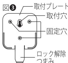
③引っ掛ける場合は中央のネジ受けを利用。固定する場合は3カ所の穴を壁面にネジ止めしてください。ネジが効かない外壁面には、付属の樹脂リブを使用してください。(下穴を開け、樹脂リブを打ち込み、樹脂リブにネジをねじこみます。)
