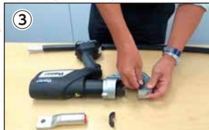
③ 工具のヘッドにダイを取り付けます。
