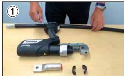
① 端子、使用ダイ、工具及び電線を用意します。
