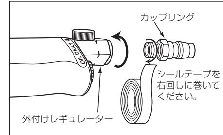
4. 外付けエアーレギュレーターで、作業に合わせてスピード調節を行って下さい。“0”から“MAX”印を90度の範囲内で調節して下さい。
