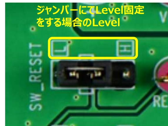
本評価基板には、TB62214AFGの動作設定を行うための、基板写真ではスイッチが実装されていますが、実際の基板には上図のようなジャンパーを設けております。
