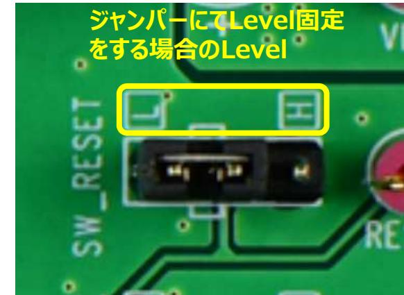
本評価基板には、TB62218AFGの動作設定を行うための、基板写真ではスイッチが実装されていますが、実際の基板上には上図の様なジャンパーを設けております。
